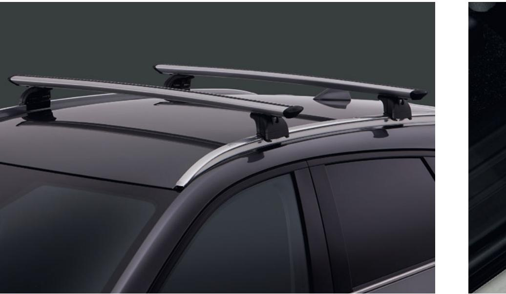
Uzdužni i poprečni krovni nosači
